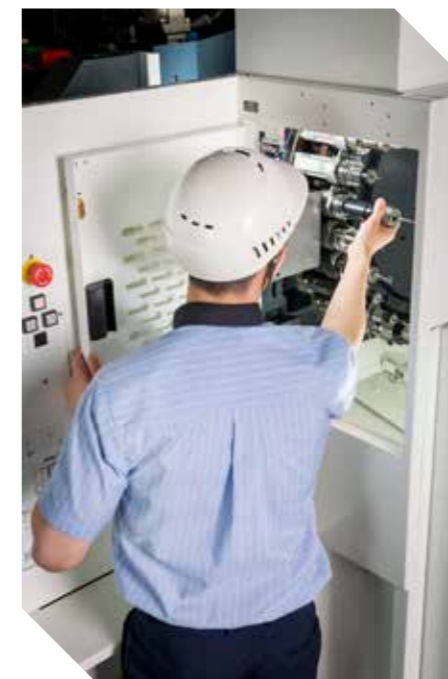
刀库在机床侧面, 方便在ATC刀库装卸刀具
