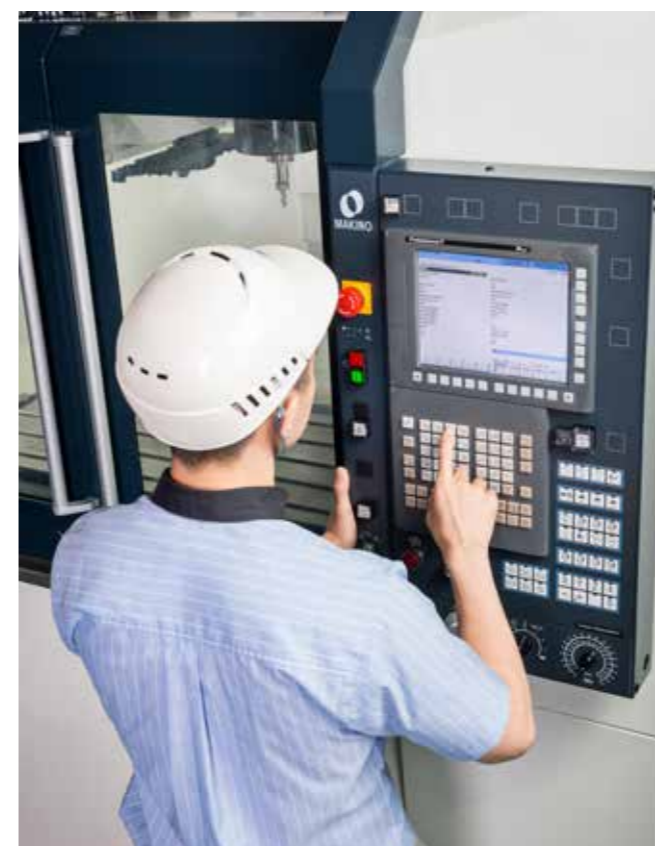
操作面板90°摆动, 更方便操作机床, 为工程师提供良好的手眼协作性
