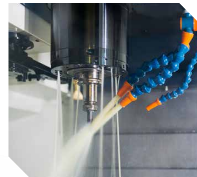
3.0 MPa 贯穿主轴冷却液 (选配) 旋风过滤器 (选配) 60 把刀库 (选配)
